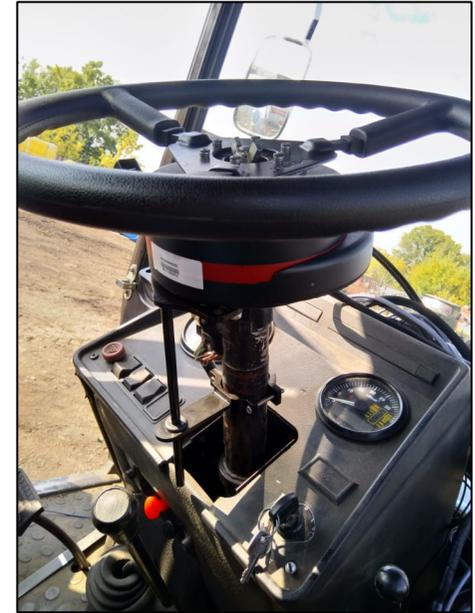
Пример установки системы «Агронавигатор-Автуруль» на самоходный опрыскиватель на шасси ГАЗ 66
